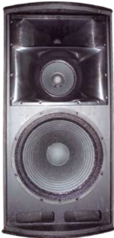
Widok kolumny po zdjęciu kraty osłonowej: na dole umieszczono standardowy przetwornik 15", a powyżej plastikowy zespolony horn dla głośnika średnio- i wysokotonowego.
